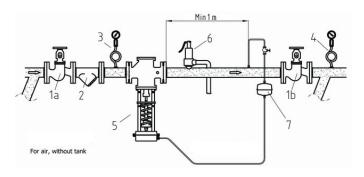
Montaje alternativo para líquidos y gases neutros hasta 80°C
