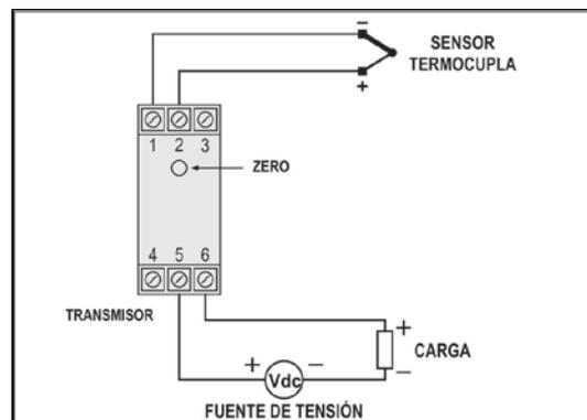
Fig. 07 – Conexiones eléctricas del transmisor – Termocupla
