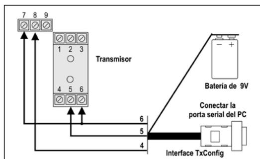
Fig. 01 – Conexiones de la Interface TxConfig modelo RS232
