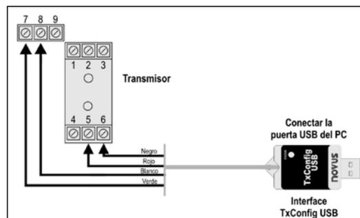
Fig. 02 – Conexiones de la Interface TxConfig modelo USB
