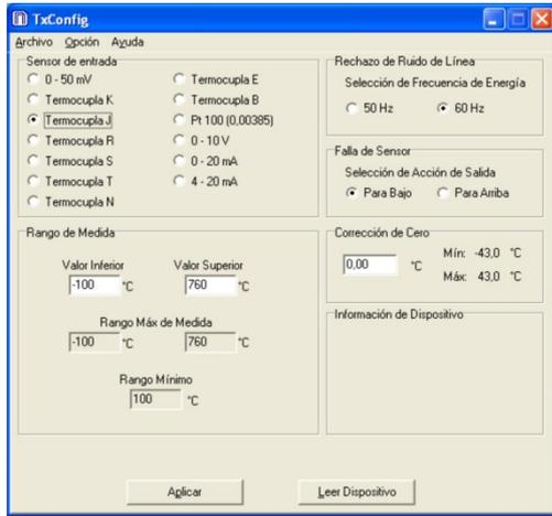
Fig. 03 – Pantalla principal del software TxConfig
