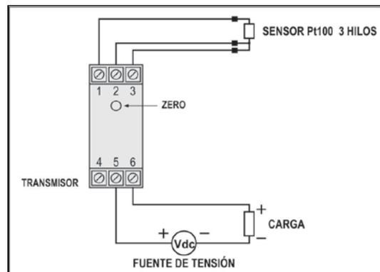
Fig. 06 – Conexiones eléctricas del transmisor – Pt100
