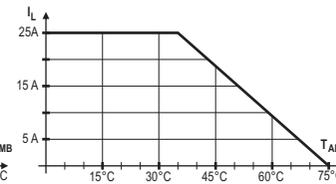
Fig 4 - SSR2525/4825 + disipador ND25-120 mm
