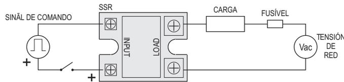
Fig 1 - Conexiones eléctricas
