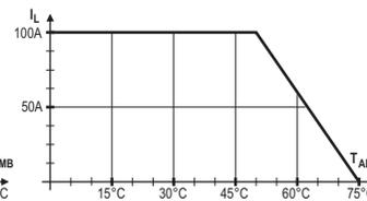
Fig 8 - SSR48100 + disipador NDP3-120 mm + Ventilador 3 m/s
