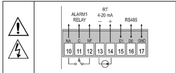
Figura 03 - Conexiones de alarma, retransmisión y comunicación
