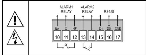
Figura 02 - Conexiones de alarmas y comunicación serial
