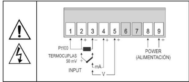
Figura 01 - Conexiones de las entradas y alimentación
