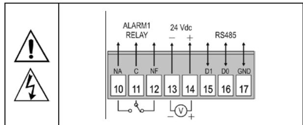
Figura 04 - Conexiones de alarma, fuente auxiliar y comunicación
