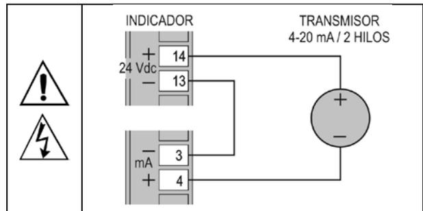
Figura 05 - Ejemplo de utilización de la fuente de tensión auxiliar del indicador
