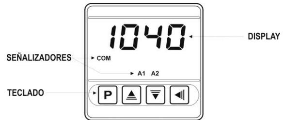
Figura 06 - Identificación de las partes del panel frontal
