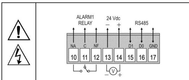
Figura 04 - Conexiones de alarma, fuente auxiliar y comunicación
