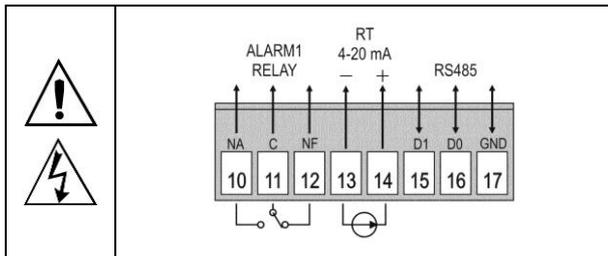
Figura 03 - Conexiones de alarma, retransmisión y comunicación
