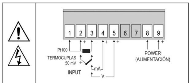
Figura 01 - Conexiones de las entradas y alimentación
