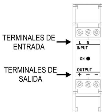
Figura 1 – Conexiones
