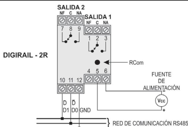
Figura 2 – Conexiones Eléctricas
